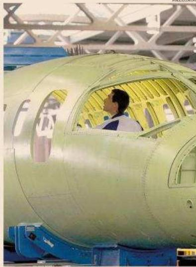
P.180. La fusoliera di un bimotore P.180 in fase di assemblaggio
